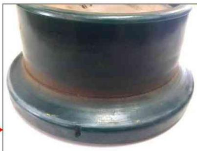
試験用トロに2,000kgの荷重を積載し時速5km/hで約300km走行。
