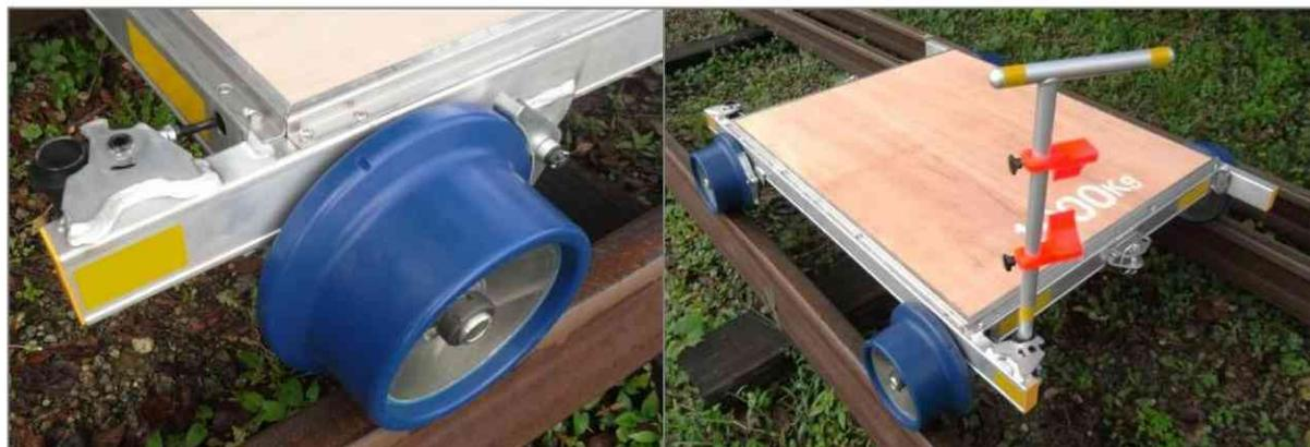
小径車輪は現行品よりもつば長さを短縮、肉厚を上げ断面強度をさらに向上
